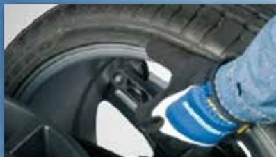
Die Techniker legen einfach den Messarm an die Felge an und das System gibt automatisch die Felgenmaße ein und wählt den geeigneten Auswuchtmodus.
